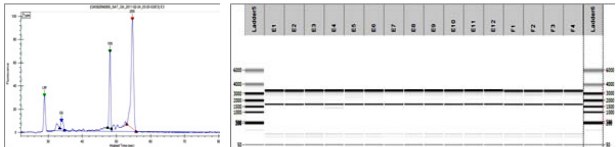
Figure 2: 식물 시료에서 추출된 total RNA의 LabChip GX 분석 결과
