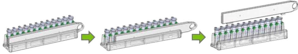
그림 4. Magnet plate 분리 방법. Magnet plate를 화살표 반대 방향으로 당겨 분리합니다.
