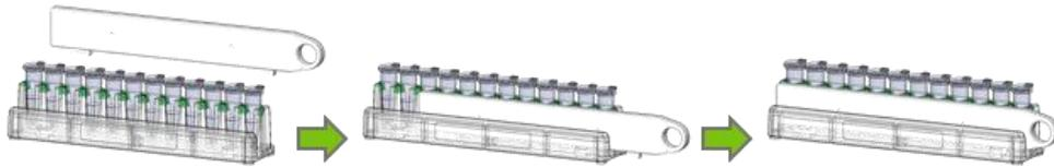
그림 2. Magnet plate 장착 방법. Stand의 장착부에 Magnet plate를 화살표 방향으로 밀어 결합합니다.
